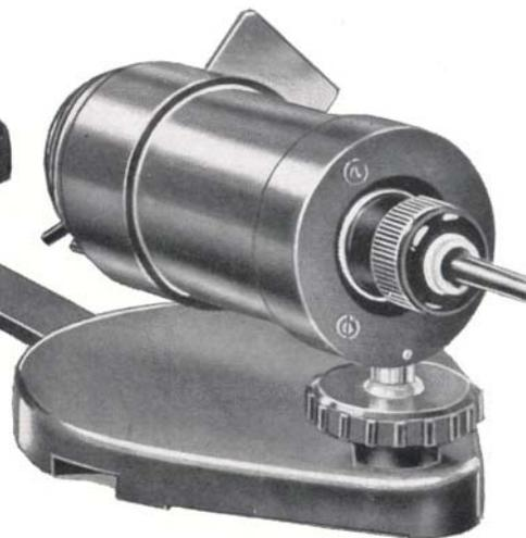
Das nebenstehende Bild zeigt das mit einem Gleittisch H3 ausgerüstete Lg-Stativ. Auf den Tubus ist ein Projektionszeichenspiegel aufgesetzt, der das Nachzeichnen des auf die Tischfläche projizierten Bildes eines mikroskopischen Objektes ermöglicht.
