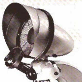
Bild 19: Projektionsaufsatz mit Projektionsscheibe und Vergleichsstandard. Ausziehbarer, monokularer Tubus mit Strichplattenrevolver und Okular K 10x Br.
