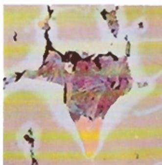
Bild 17: Covollin mit Kupferglanz, Kupferkies und Pyrit; aufgenommen mit Objektiv ANTI-FLEX-EPI-Achromat 16/0,40 Oel im einfach polarisierten Licht.
